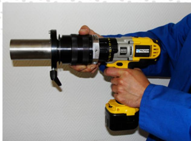
Portable, compacte, légère, très facile d'utilisation, la machine **SE 65** permet de réaliser le dressage de faces de tubes fins. La préhension s'effectue sur la partie extérieure du tube avec des douilles de serrage. Une douille de serrage est nécessaire pour chaque diamètre
